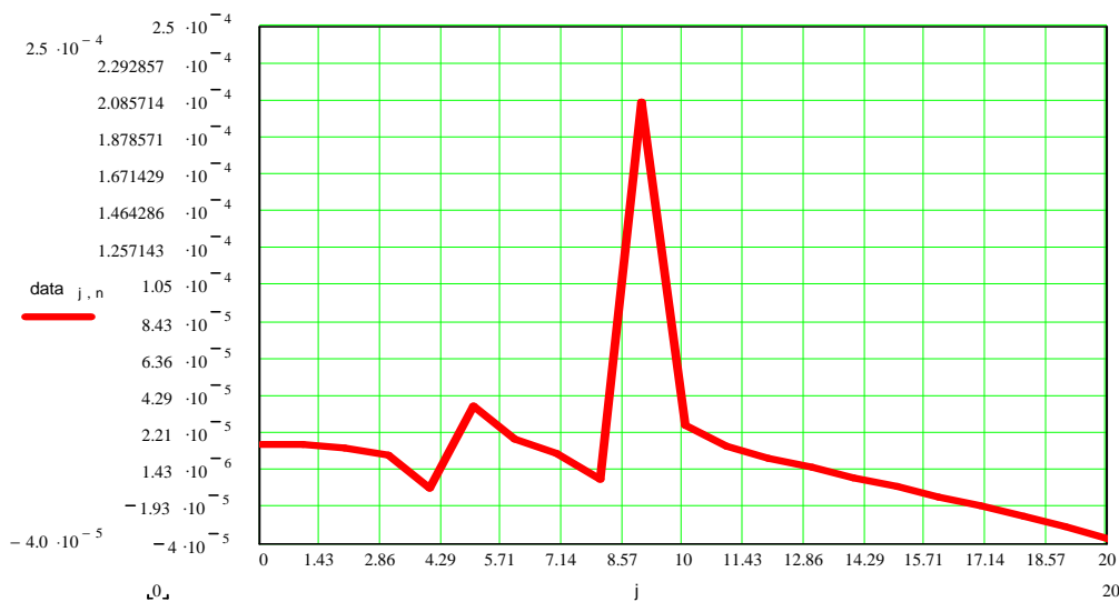
Рис. 2. Амплітудно-частотна характеристика передавальної функції ланцюгової приведенної схеми динамічної моделі шламового насоса типу АНПМ-9000
