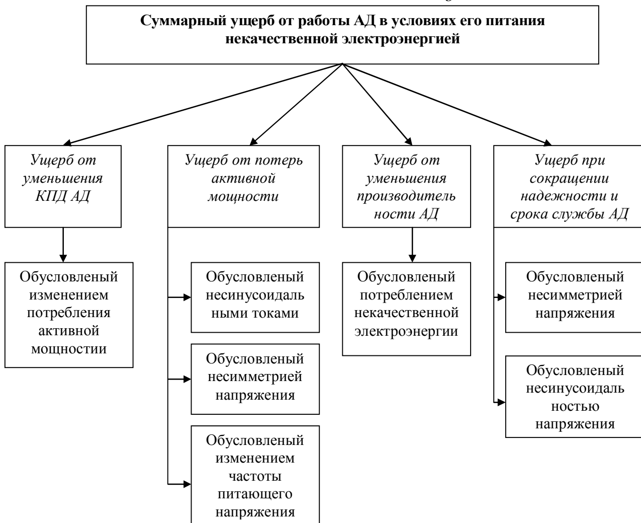
Рис.1. Структура и факторы, влияющие на экономический ущерб, вызванный работой АД в условиях его питания некачественной электроэнергией
