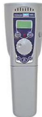
Рис. 2. Стробоскоп TMRS 1 производства фирмы SKF
