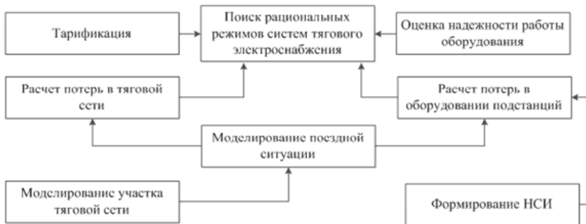
Рис. 2. Структурная схема программного комплекса
