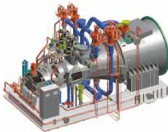
Рисунок 3.1 – Одноциліндрова безредукторна турбіна з центральним підведенням пари і поворотом потоку для приводу генератора
