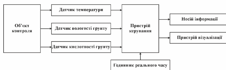
Рисунок 1 – Структура стенда системи збору та візуалізації інформації про стан ґрунту верміферми
