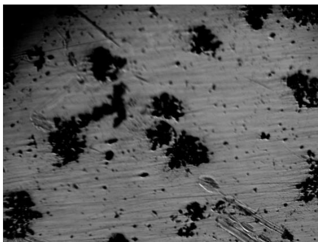
Рисунок 2.3 – Мікроструктура ковкого чавуну (збільшення у 800 разів)
