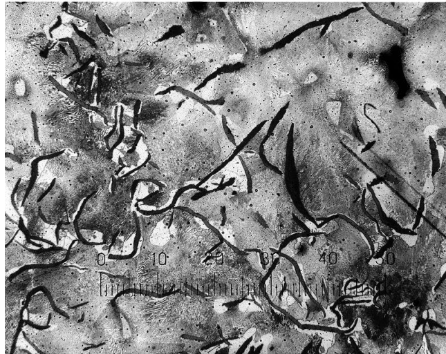
Рисунок 2.1 – Мікроструктура сірого чавуну (збільшення у 800 разів)
