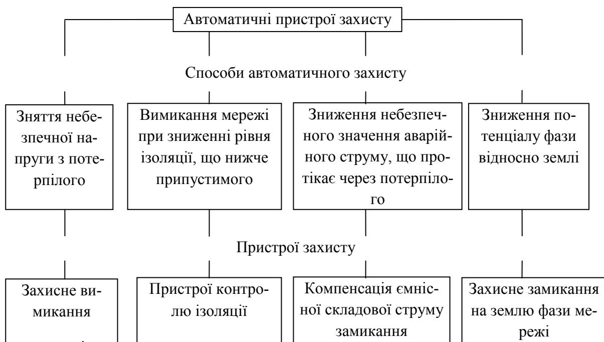
**Рисунок 5.1 Класифікація способів та пристройів автоматичного захисту від електричних уражень високовольтних мережах шахт**
