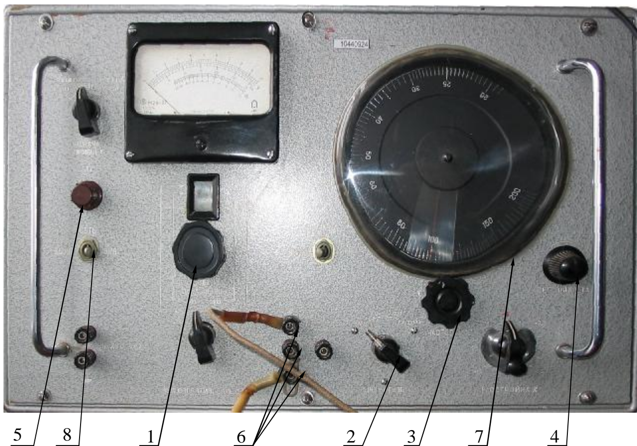
Рисунок 4.2. – Передня панель генератора синусоїдального сигналу звукової частоти: 1 – перемикач режимів роботи; 2 – перемикач множника; 3 – регулятор плавної зміни частоти; 4 – регулятор напруги; 5 – запобіжник; 6 – виводи; 7 – обертовий індикатор; 8 – вимикач напруги живлення
