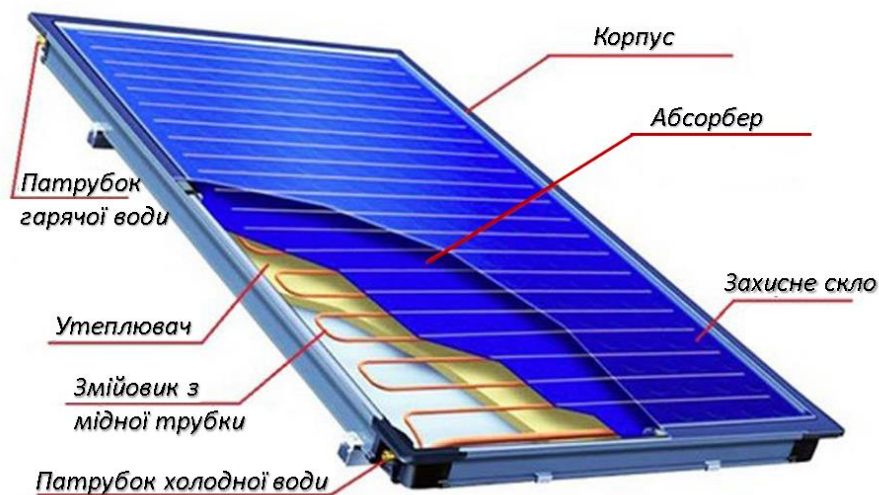
Рисунок 2.5 – Будова плоского сонячного колектора
