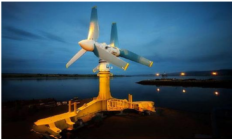
Рисунок 2.73 – Найбільша у світі двороторна припливна турбіна АК-1000 (висота 22 метра, вага 130 тон, потужність 1,2 МВт)
