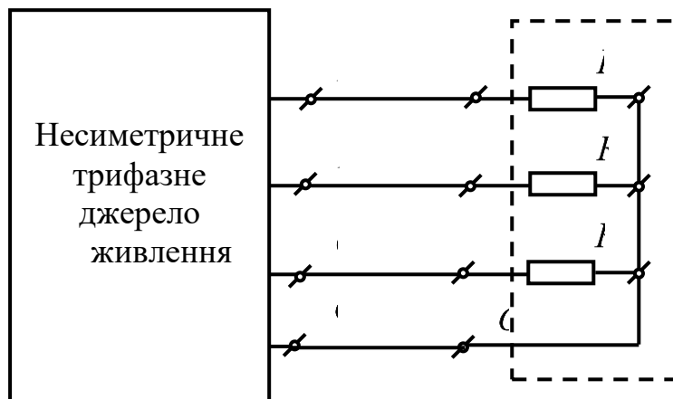
Рисунок 3.2. – Чотири провідна мережа з несиметричним трифазним джерелом живлення та симетричним активним навантаженням
