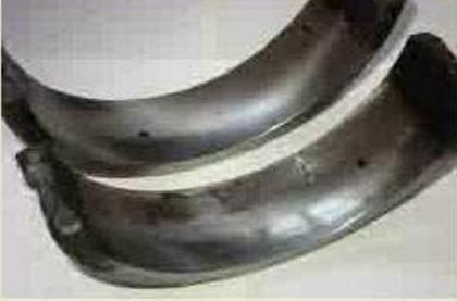
Рисунок 2 - Следы неравномерного износа наружного кольца подшипника
