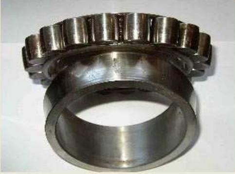
Рисунок 1 - Следы ложного бринеллирования на внутреннем кольце и телах качения
