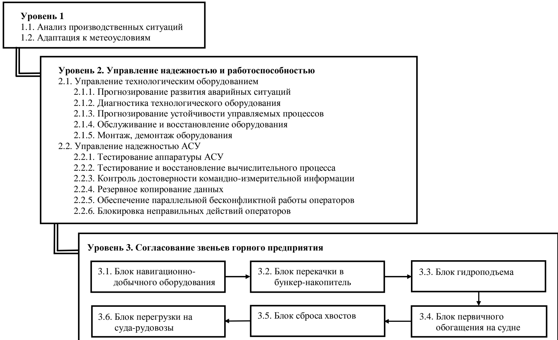
Рис.2. Укрупненная блочно-иерархическая структура АСУ горно-морского предприятия
