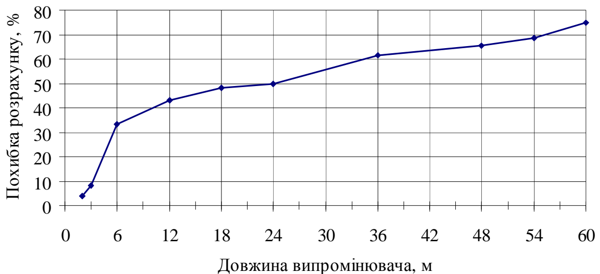
Рис.3. Залежність похибки розрахунку тривалості процесу нагріву приміщення на моделі із зосередженими параметрами від довжини випромінювача
