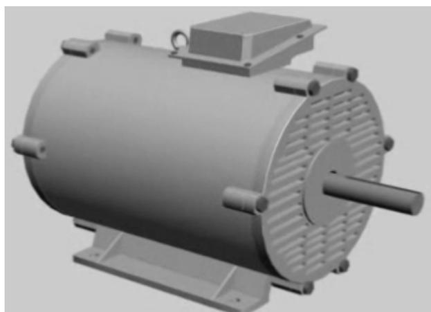
Рис. 10. Трехмерная модель синхронного двигателя
