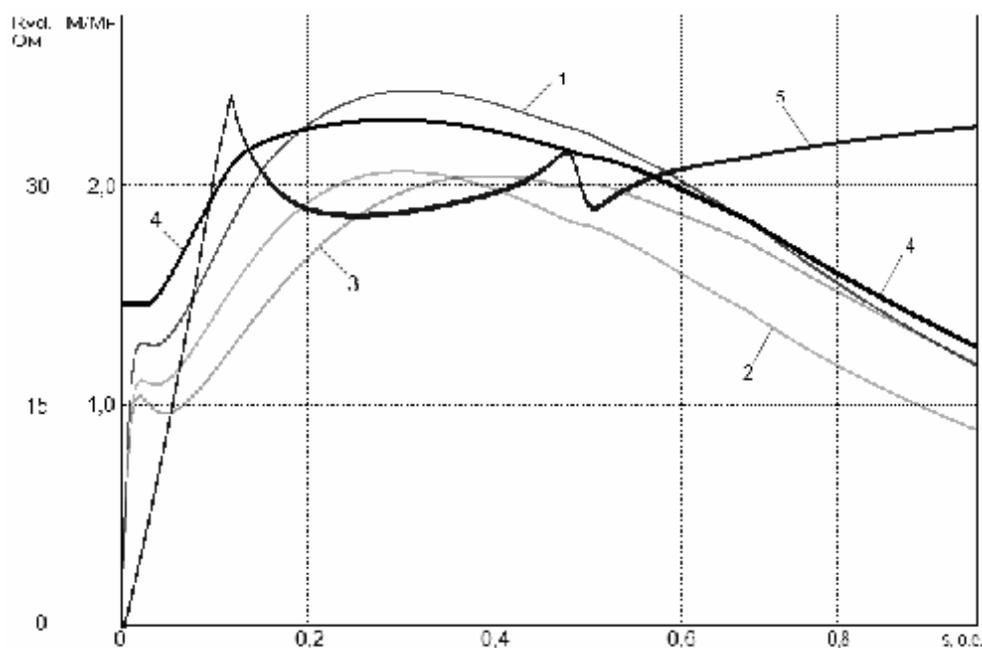
Рис. 2. Кривые пусковых механических характеристик СДМ32-24-59-80УХЛ4 (4 МВт)
