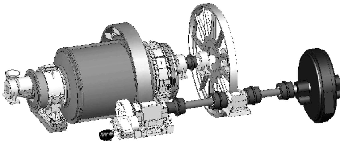
Рис. 4. Общий вид ресурсосберегающей мельницы принудительного самоизмельчения МПС(Р)-3600х3100А, адаптированной к фундаментам заменяемых мельниц МГР-4000-7500 Ингулецкого ГОК (г. Кривой Рог)
