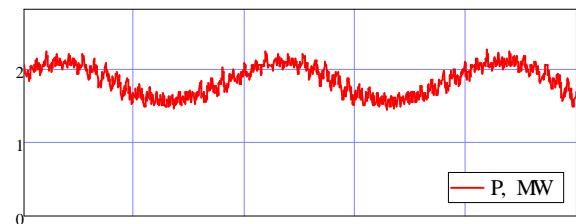
Рис. 12. Кривая мгновенной мощности электродвигателя Д4
