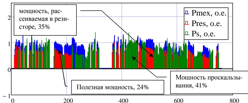
Рис. 1.4. Энергетические диаграммы электровоза при работе в режиме проскальзывания
