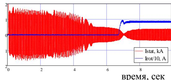
Рис. 10. Осциллограмма пуска двигателя Д4
