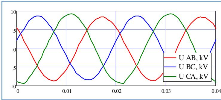
Рис. 7. Осциллограммы линейных напряжений подстанции цеха №2
