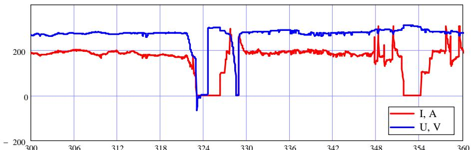
Рис. 6. Оциллограммы напряжения контактной сети и тока, потребляемого электровозом, при работе на участке в районе силовой подстанции
