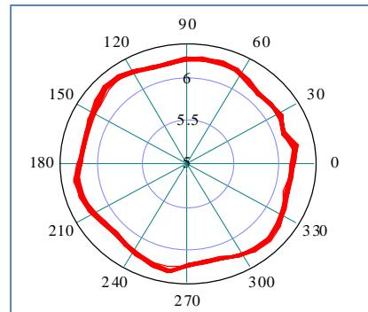
Рис. 8. Годограф линейного напряжения подстанции цеха №2
