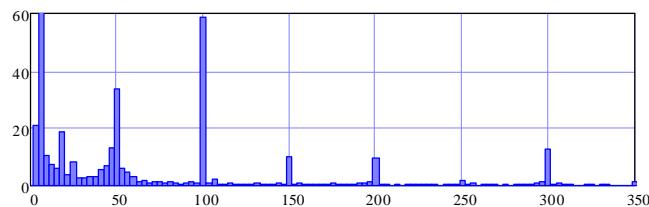
Рис. 13. Спектр мгновенной мощности электродвигателя Д7
