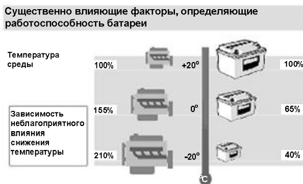
Рис. 1. Влияние температуры электролита на разрядно-зарядный потенциал стартерной АБ
