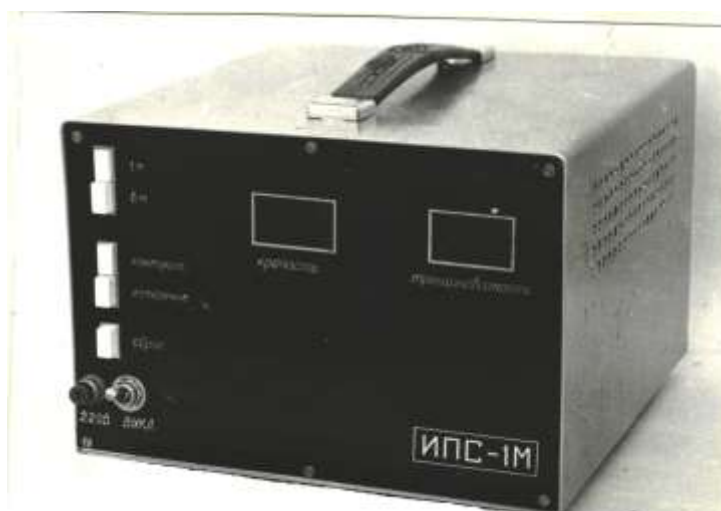
Рис. 4. Общий вид прибора для измерения крепости и трещиноватости буримых пород
