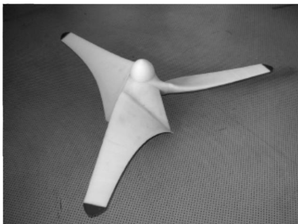
Рисунок 3.7 – Геометрія лопатей вітроколеса зі скруткою.
