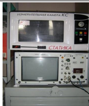
Рис. 3. Схема установки з вимірювання електростатичного потенціалу на поверхні фільтрувального матеріалу
