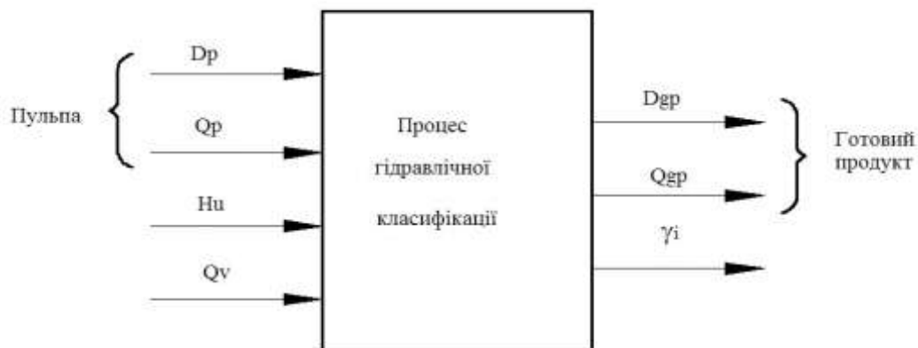
Рис. 1. Структурна схема моделі гідравлічного класифікатора
